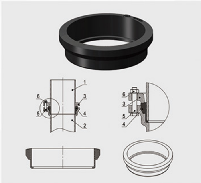
说明：1. 直管 2. 承口端 3. 法兰压盖 4. 减震补偿密封胶圈 5. 螺栓 6. 螺母
