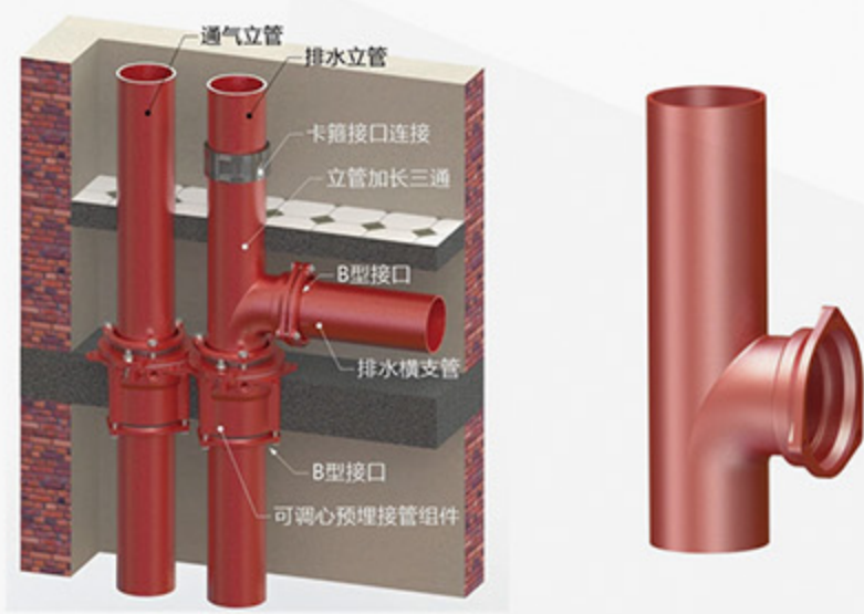
图 5 与加长三通管件连接示意图
