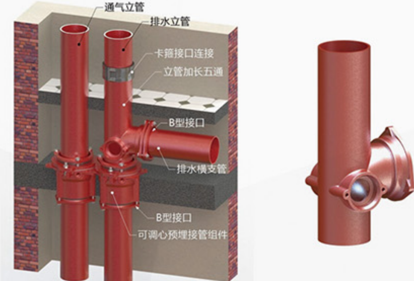
图 6 与加长三通管件连接示意图
