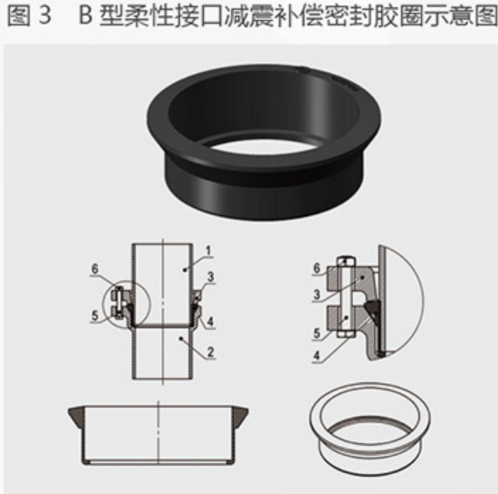
说明：1. 直管 2. 承口端 3. 法兰压盖 4. 减震补偿密封胶圈 5. 螺栓 6. 螺母
